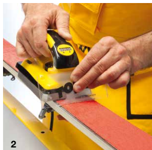
Abb. 2) Wax in Haarrichtung einbügeln. Optional kann die Abziehklinge direkt hinter das Bügeleisen gehalten und überschüssiges Wax gleich wieder abgezogen werden. Bügeleisen einmal von Skispitze bis Skiende führen.
