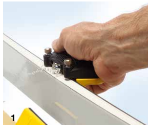
Abb. 1) Hobeln der Seitenwangen. Steht die Feile auf der Seitenwange auf, entfernen Sie das Seitenwangenmaterial mit dem Sidewall Planer Pro.
